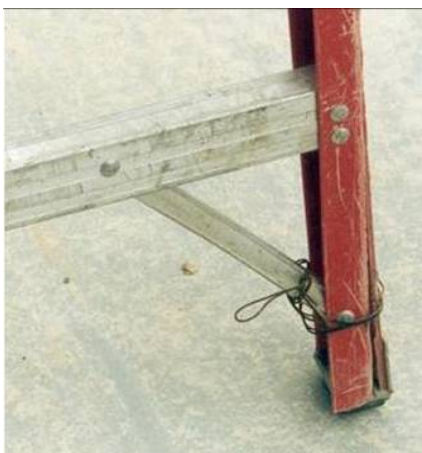
Esta foto es un ejemplo de una escalera que debe de ser retirada de servicio. La pata se ha dañado y alambre se utiliza para mantener la pata unida.
